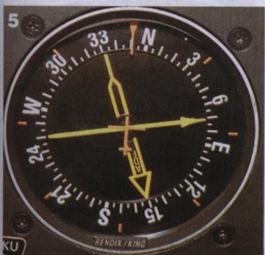
Przykłady oznakowania i opisu tarcz niektórych przyrządów pokładowych: 1 i 2 - prędkościomierze; 3 i 4 - wskaźniki ścieżki ILS; 5 - busola RMI; 6 - wskaźnik zakrętu
