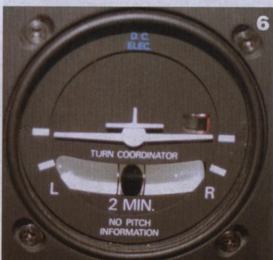
Przykłady oznakowania i opisu tarcz niektórych przyrządów pokładowych: 1 i 2 - prędkościomierze; 3 i 4 - wskaźniki ścieżki ILS; 5 - busola RMI; 6 - wskaźnik zakrętu
