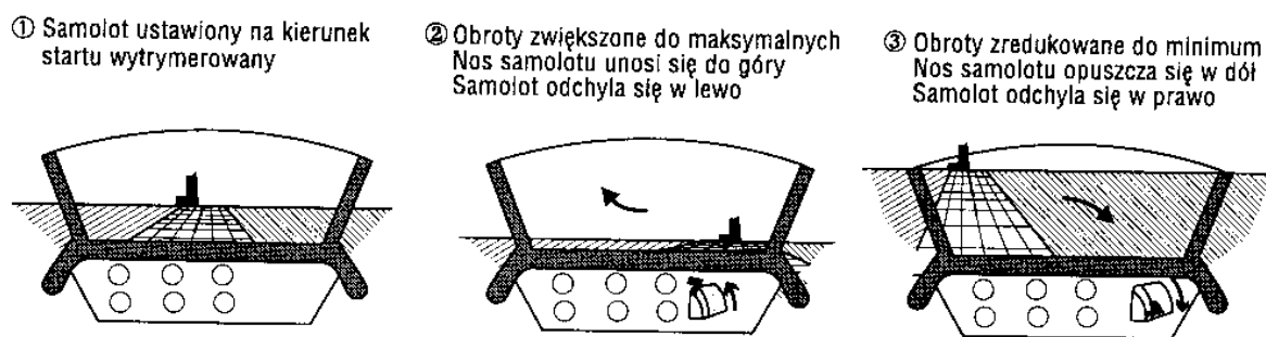
Rys. 43. Tendencja ruchu samolotu na zmianę mocy silnika (obroty silnika zgodne ze wskazówkami zegara)
